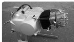
kugelgelagerte Nocke, trägheitsarme zurückverlegte 4-Scheiben Handkupplung, 4-Gang, 1-0-2-3-4 Schaltung, Kickstart, 6 o. 12 Volt, verst. Ölpumpe, DIN ISO zertifizierter Hersteller, incl. ungedr. CDI, Schalthebel, Kickstarter, Zündspule, Deckel ohne Schriftzüge
