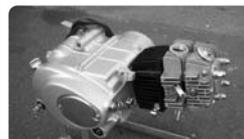
23/27 mm Ventile, kugelgelagerte Nocke, 3-Scheiben Handkupplung, 4-Gang, 1-0-2-3-4 Schaltung, Kickstart, 12 Volt, verstärkte Ölpumpe, DIN ISO zertifizierter Hersteller, incl. ungedr. CDI, Schalthebel, Kickstarter, Zündspule, Deckel ohne Schriftzüge
