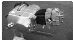
kugelgelagerte Nocke, 2-Scheiben Handkupplung, 4-Gang, Kickstart, 6 o. 12 Volt, verstärkte Ölpumpe, DIN ISO zertifizierter Hersteller, incl. ungedr. CDI, Schalthebel, Kickstarter, Zündspule, alle Deckel ohne störende fremde Schriftzüge
